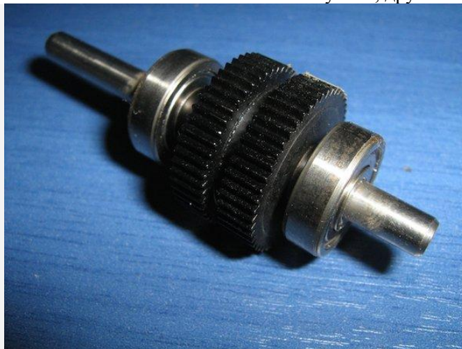
Рис. 8 Два 50-зубых диска помещены сверху и снизу постоянного магнита
