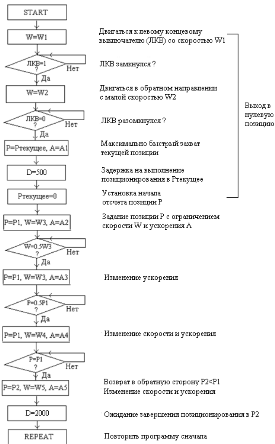
Рис. 73. Алгоритм поиска нулевой точки позиции и управления движением сервопривода
