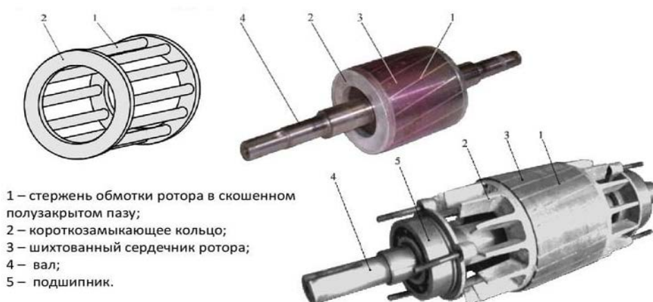
Рис. 1. Конструкция короткозамкнутого ротора
