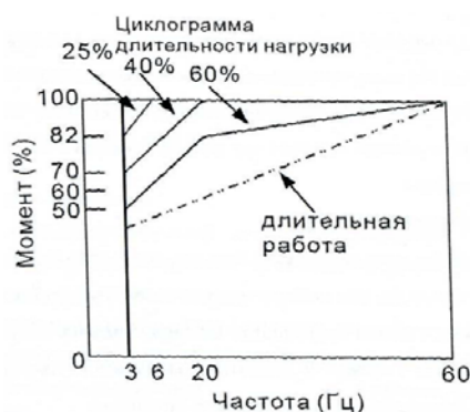
Рис. 34. Допустимые нагрузки для стандартного АД при скоростях вращения, меньших номинальной
