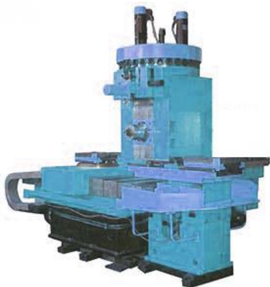
Рисунок 2.6. Обрабатывающий центр с ЧПУ ИР500ПМФ4
