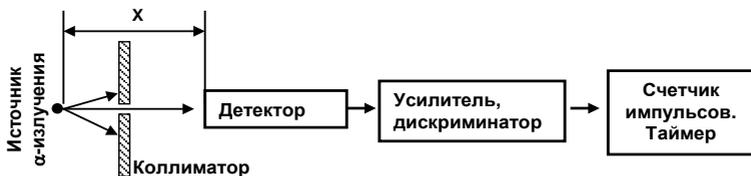
Рис. 5.2. Функциональная схема лабораторной установки
