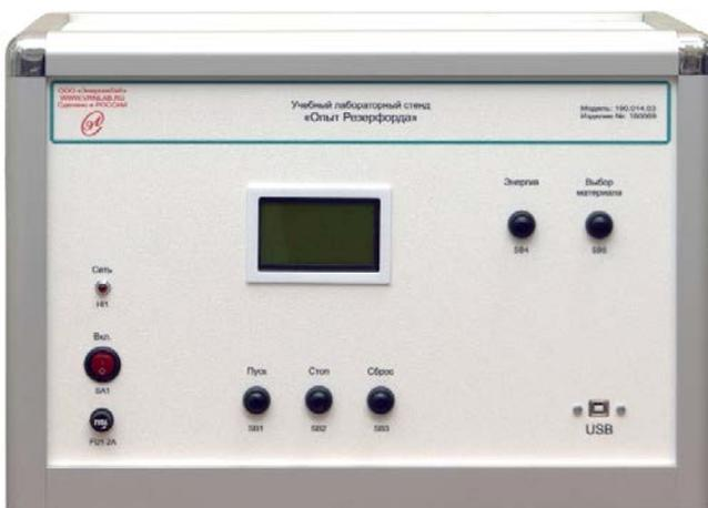
Рис. 3.7. Внешний вид установки «Модель опыта Резерфорда»
