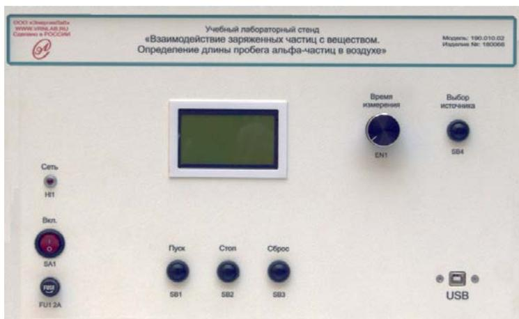
Рис. 5.1. Блок управления оборудованием стенда
