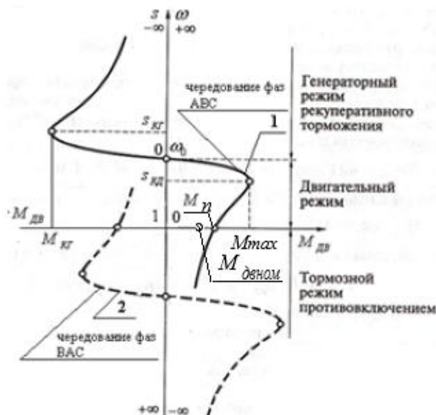
Рис. 3 Естественные механические характеристики трехфазного АД с кз ротором
