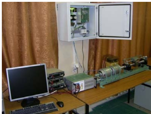
Рис. 1. Лабораторный стенд для исследования характеристик электропривода
