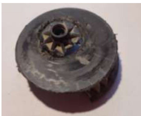
Рис. 1. Крыльчатка компрессора, требующая замены
