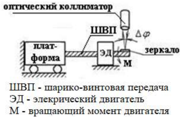
Рис. 2. Схема стенда для экспериментального определения жесткости механических звеньев
