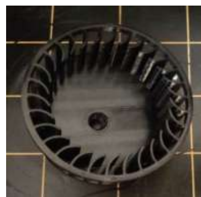
Рис. 4. Крыльчатка, созданная методом 3D-печати
