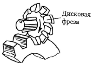
Рис. 1.2. Нарезание зубьев модульной дисковой фрезой
