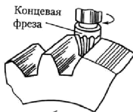
Рис. 1.3. Нарезание зубьев модульной концевой фрезой
