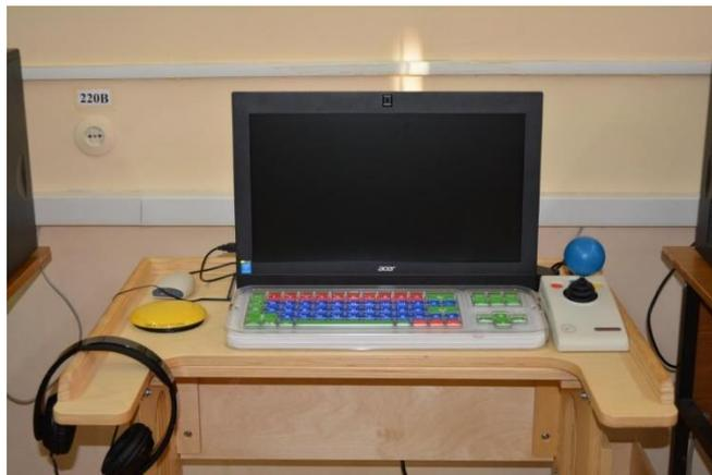
Для людей с ограниченными возможностями для занятий в компьютерных классах 303 и 202: специальный программно-технологический комплекс, беспроводная выносная большая кнопка, беспроводная клавиатура с большими кнопками, беспроводной компьютерный джойстик с двумя выносными кнопками, беспроводной ресивер, гарнитура компактная.
