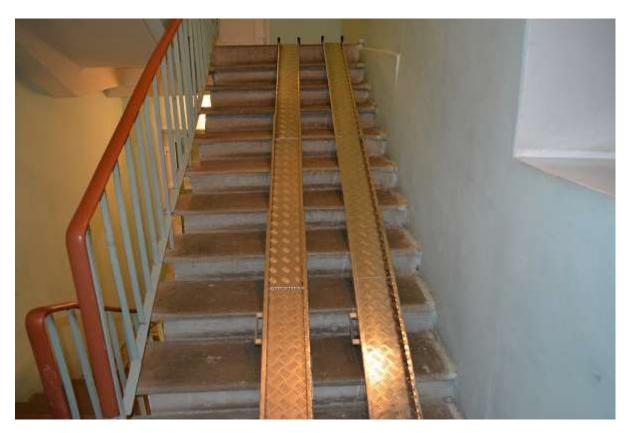
Пандус-платформа обеспечивает возможность подъема людей на инвалидных колясках в тех местах, где нет стационарных пандусов и лестничных подъемников.
